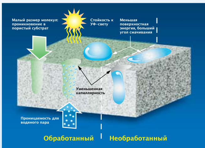
Рис. 2. Продукты на основе силиконов проникают на большую глубину, образуя внутри субстрата водоотталкивающий слой.
